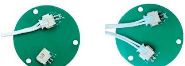
Підключення датчiku по окремій лінії робиться контактами "швидкомонтаж", а декількох датчиків методом "зірка". Для під'єднання їх до контролеру, кінці проводів обрізаються.
